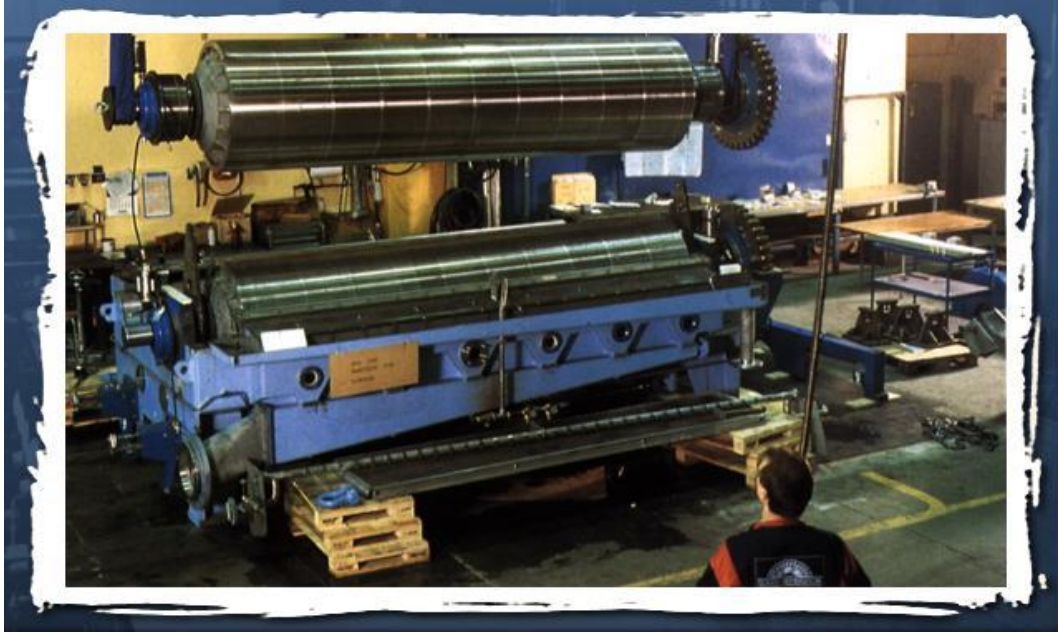
Şekil 2.5 Yaş preslemede kullanılan yivli pres (Anon., 1997).
