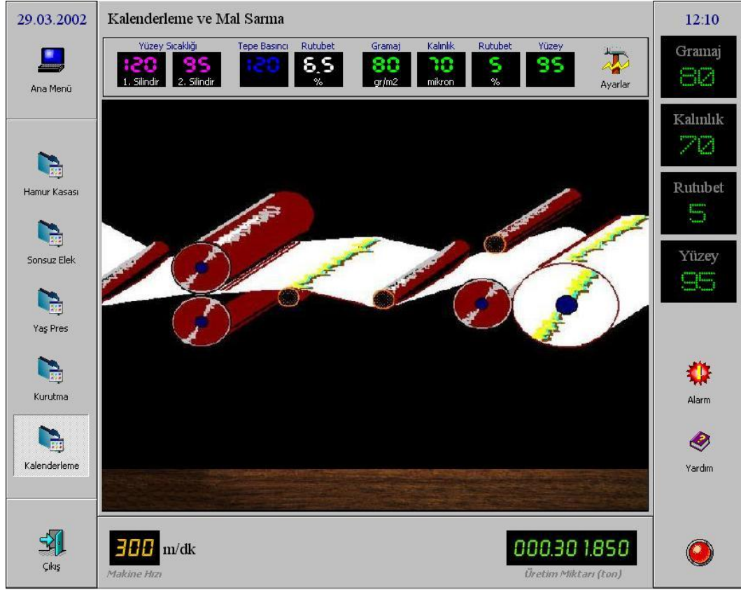
Şekil 3.10 Kalenderleme ve bitirme işlemleri.
